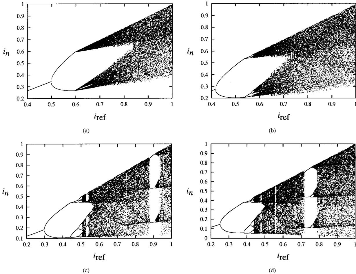
Fig. 11. Bifurcation diagrams using the iterative map. (a) Via quasi- $4T$  orbits ( $\gamma = 0.125$ ). (b) Via quasi- $8T$  orbits ( $\gamma = 0.25$ ). (c) Via quasi- $16T$  orbits ( $\gamma = 0.48$ ). (d) Via period-doubling ( $\gamma = 0.625$ ).
